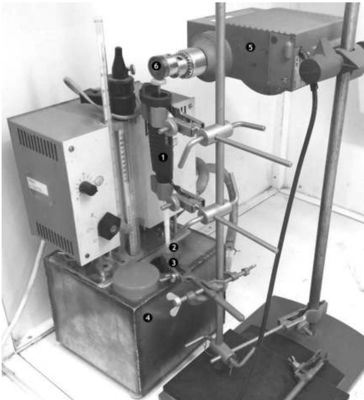
**1 – пипетка 200 мкл, 2 – сменный наконечник, 3 – пробирка с образцом, 4 – водяной термостат, 5 – мешалка «RW16 basic» («ИКА», Германия), 6 – эксцентрик с шариковым подшипником, закреплённый в патроне мешалки**
